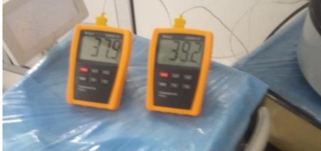
الشكل (4) :القراءات الحرارية أثناء إجراء التجارب للنقطتين عند الذروة و قبل 5 ملم من الذروة
