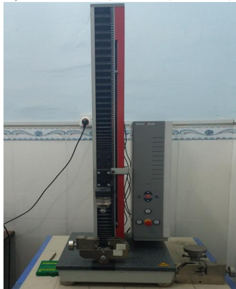
الشكل رقم (4) صورة فوتوغرافية تبين جهاز قياس الخواص الميكانيكية (Tensile).
