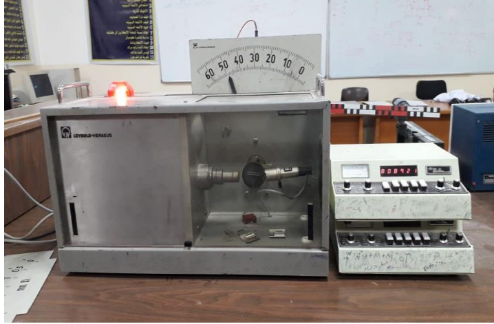
الشكل رقم (3) صورة فوتوغرافية توضح كاشف عداد كايكر لجهاز مولد الأشعة السينية نوع (LEYBOLD-HERAEUS)
